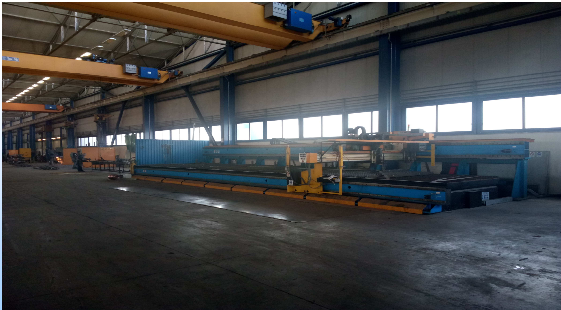
Impianto combinato taglio (plasma e ossitaglio) e unità di foratura.
